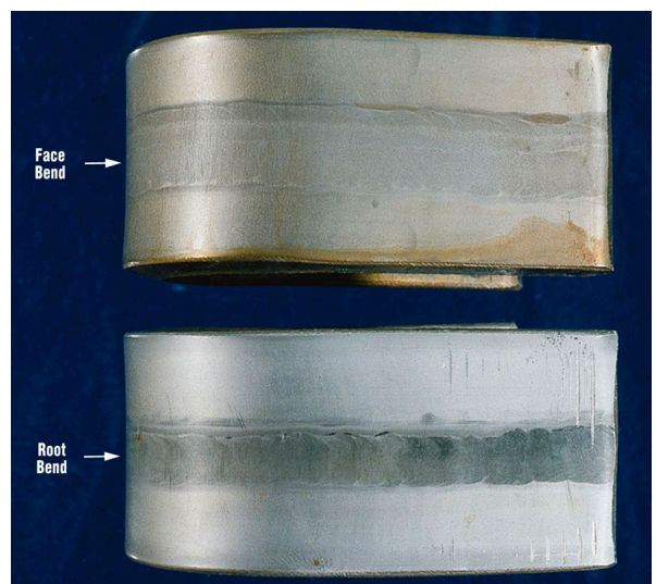
Longitudinal Weld Bends
